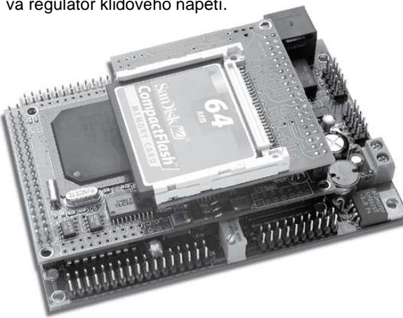
FlashCore-B s 50 pinovou zásuvkou a jednou 1GB CompactFlash deskou
